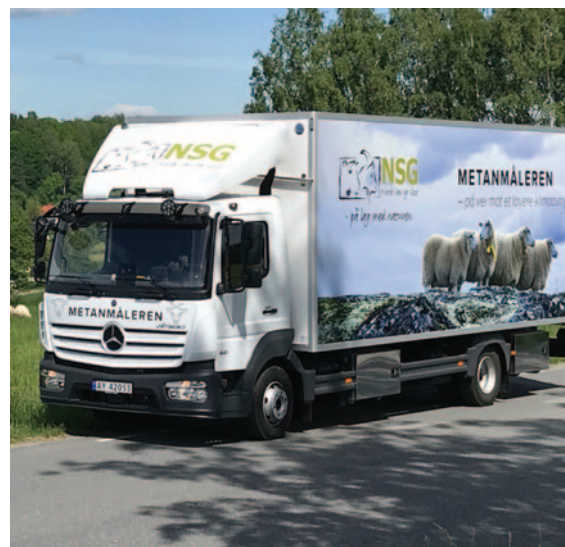
NSG har kjøpt en stor Mercedes lastebil som har fått navnet «Metanmåleren», og som inneholder et mobilt laboratorium, der man kan måle metangassutslippet fra 10 sauer samtidig. Foto: Lars Erik Wallin
