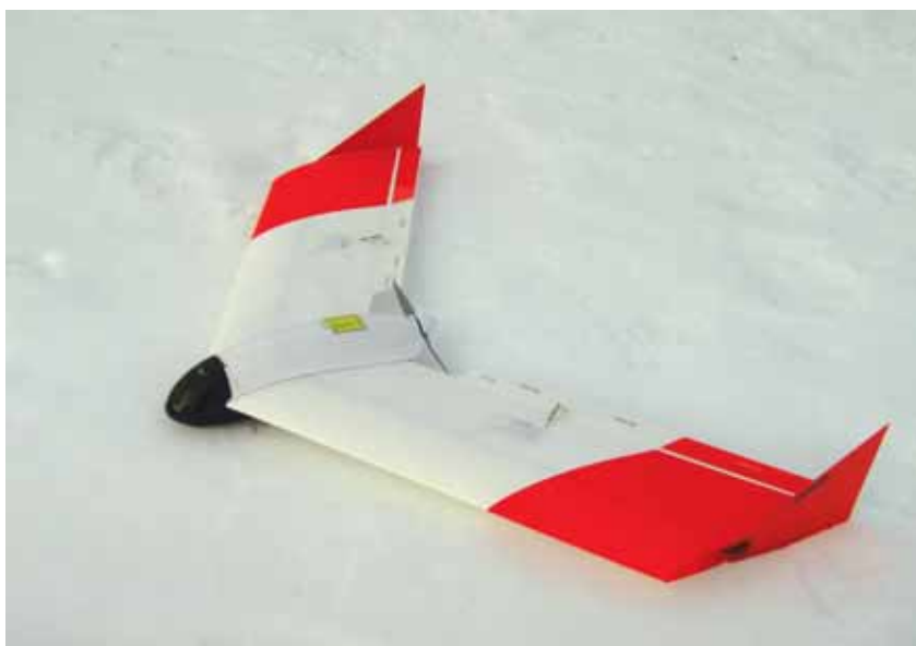
Eksempel på fast-ving flydrone som kan fotografere et større område. (Foto: Smartplanes AB)
