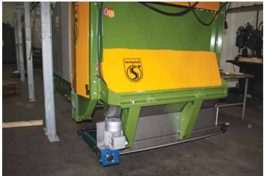
Samtlige rundballekuttere fra Serigstad Agri kan nå leveres med sidetransportør, som ekstrautstyr, i 2 ulike bredder. I en periode er disse blitt testet ute hos kunder, men er nå endelig klare for vanlig salg. De er produsert i rustfritt materiale og kan ettermonteres på tidligere modeller. (Foto: Serigstad Agri)
