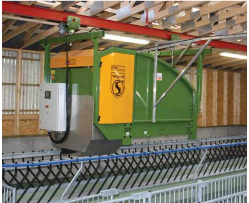
Bildet viser prototypen av OneTouchFeeder som er videreutviklet fra den velprøvde Serigstad-FlexiFeed. Fôrutmateren er her montert i et sauefjøs med plass til 200 vfs. Planlagt utfôring blir programmert i OneTouchFeederen. Så alt en trenger å gjøre er å trykke «start utfôring» - derav navnet «OneTouchFeeder». Legg merke til «trakta» under utfôrerens. Denne kan tilpasses ulike fôrbrett, og dermed sikre nøyaktig plassering av fôret. (Foto: Serigstad Agri)
