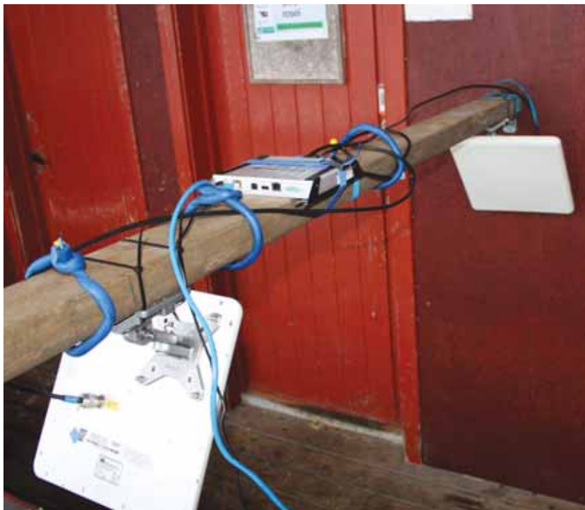
Under demonstrasjonen på saueffjøset ved NMBU var det rigget opp to antenner for avlesing av øremerkene når dyra passerte gjennom drivegangen.
