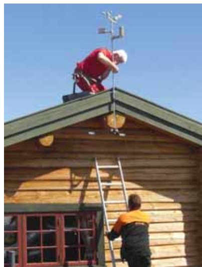
Montering av verstasjon på sætra til forsøksvert Håkon Gjelstad i Øystre Slidre.
