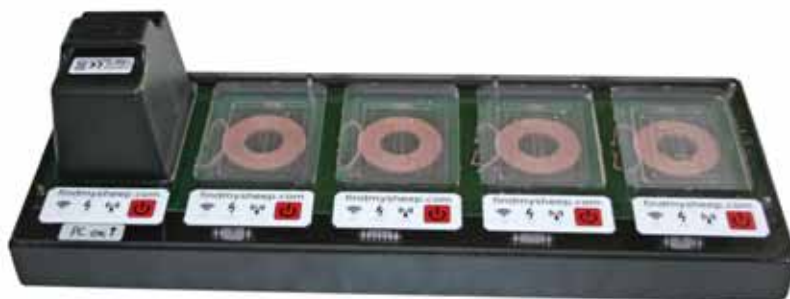
INDUKTIV LADING: Ladebrettet har plass til 5 E-bjøller, og ladetiden er fra to til to og en halv time hvis batteriene er helt tomme. Ladestasjonen helt til venstre benyttet til programmering og oppdatering av E-bjøllene.
