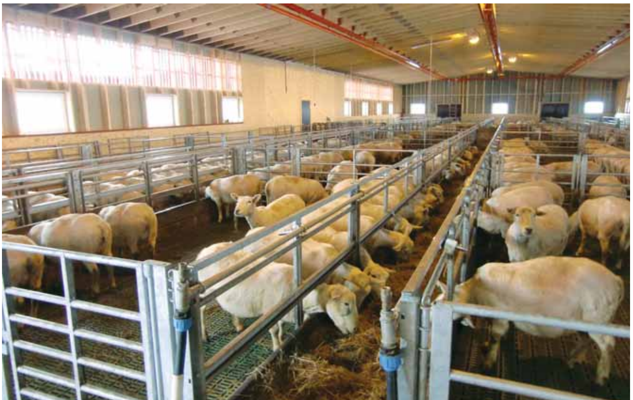
Brukerne var mer fornøyd med føringssystem/føring i sauefjøs med langsgående binger og førbrett sammenlignet med tverrstilte.
