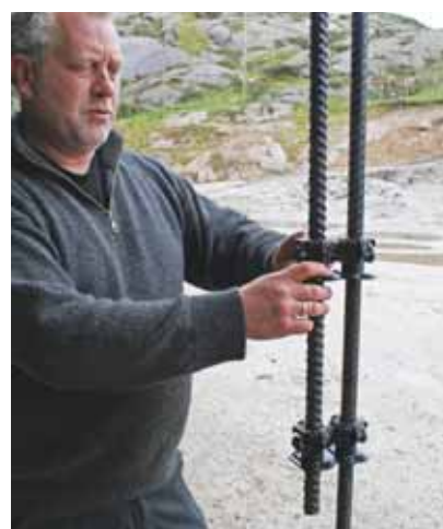
EKSTRA HØYDE: Brakettens utforming gjør det også enkelt å forlenge pålens lengde.
