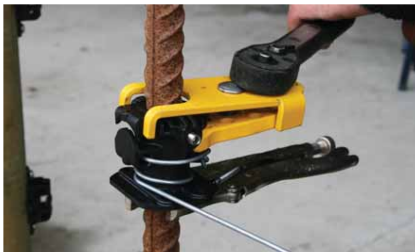
STRAMMEVERKTØY: Gjerdestråden strammes med et spesialverktøy med skralle.
